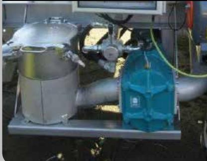
Fourniture et pose d'une pompe à lobe avec piège à cailloux en amont
