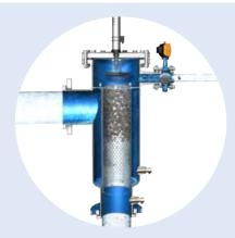
Nettoyage phase 1 Le nettoyage est enclenché par horloge ou contrôle de pression différentielle. La vanne de chasse s'ouvre, et les plus grosses particules sont évacuéres.
