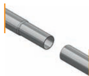
Raccordement des lisses par rétreint
