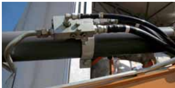
Clapets de sécurité comprises dans le kit de manutention sécurisée
