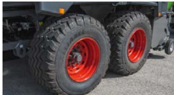
■ La Fendt Squadra 1290 UD est proposée en deux montes différentes de pneus pour respecter une largeur hors tout inférieure à 3 mètres : 620/50R22.5 et 620/55R26.5.
