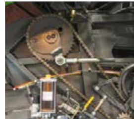
■ Tous les noueurs et les chaînes de transmission les plus importantes sont lubrifiés automatiquement. Pour les autres composants, l'intervalle de graissage peut être réglé facilement au terminal.
