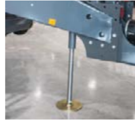
□ La béquille de stationnement hydraulique en option facilite les opérations d'attelage et de dételage du tracteur.
