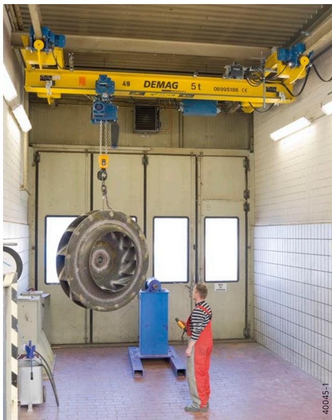
Cotes d'approche très réduites grâce à un ensemble de translation pour pont suspendu réalisé sur la base d'un chariot de palan à chaîne DC
