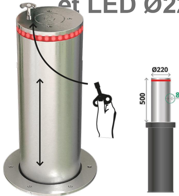
Borne conçue pour contrôler les accès sur la voie publique et dans les copropriétés, entreprises, etc. Piston en acier inoxydable AISI 304 satiné de Ø220 x 500mm de hauteur. Couvercle, châssis, attaches et visserie en acier inoxydable.
