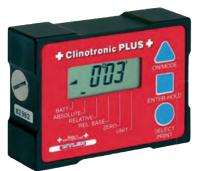
Instrument universel compact pour la mesure directe ou comparative. Etendue de mesure ± 45° (appareil standard) avec indication de l'angle ou de l'inclinaison. Cellule détectrice en technologie "SEAL-TEC" pour l'amélioration de l'efficacité dans des conditions d'environnement difficiles. Répond aux normes sévères de la CE.
