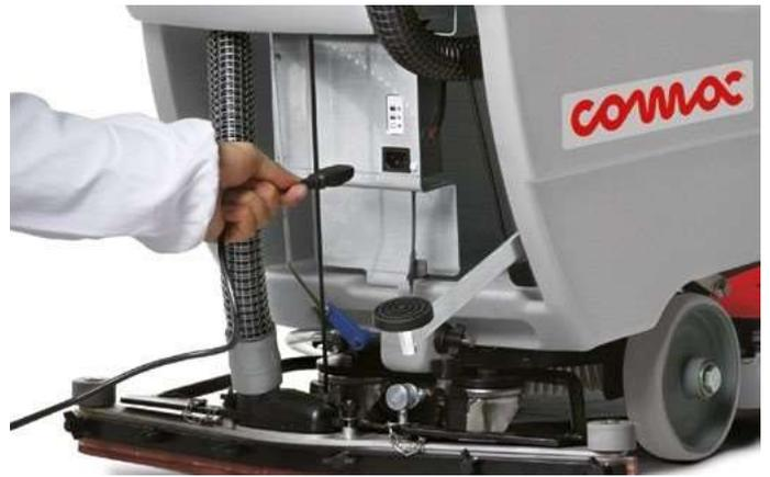
Kit de chargeur de batterie intégré sur demande, adapté aux batteries plomb et au gel.
