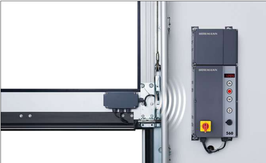
Unité de transmission sans fil Pour la transmission des signaux du tablier de porte à la commande via Bluetooth (sans câble spiralé), alimentation par une batterie puissante ; composants raccordables : optopalpeurs LE (basse consommation), cellule photoélectrique devant la baie VL1-LE / VL2-LE, listel 8k2, contacteur mou de câble, contact de portillon incorporé, contact sur verrou de nuit
