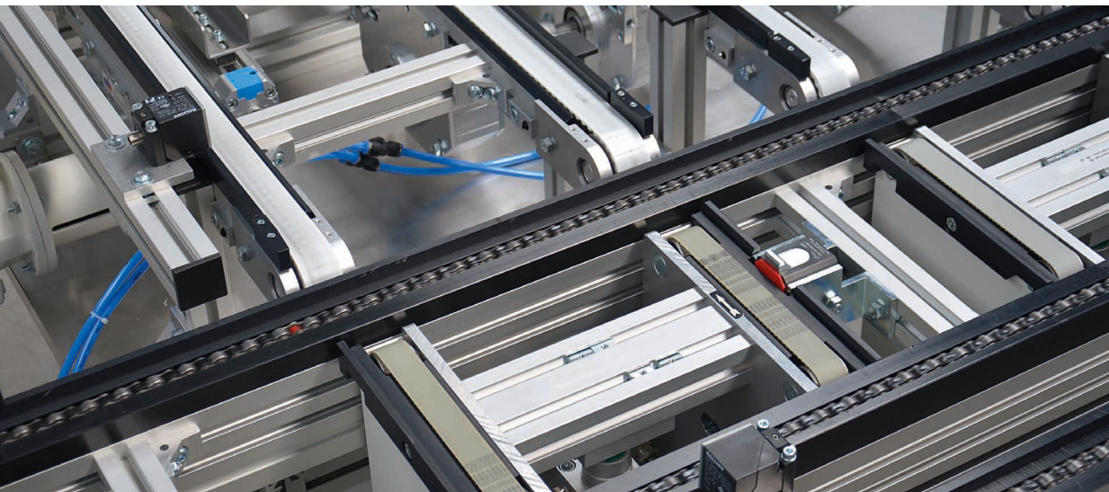
Versamove plus: éclusage des systèmes de transfert de la ligne principale en deux voies de convoyage transversales parallèles
