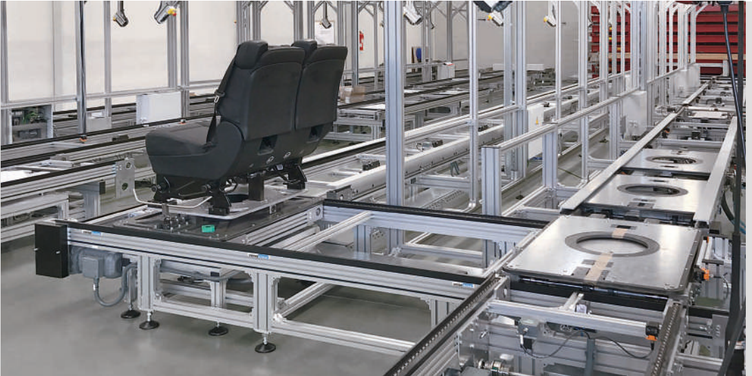
Versamove plus avec porte-pièces grand format selon les besoins du client
