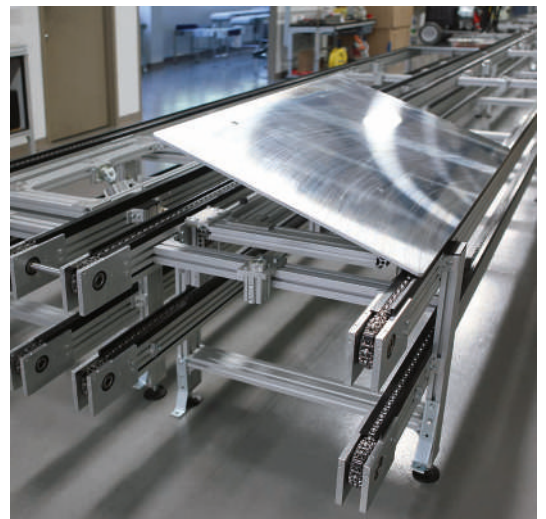
Versamove plus: deux niveaux de transport, type de convoyeur d'accumulation à rouleaux
