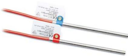
ZENNER propose des sondes de température à résistance de platine du type PT1000, PT500 et PT100 avec 2 ou 4 conducteurs. Elles sont utilisables comme sondes directes ou installées dans un doigt de gant. Toutes les sondes pour nos compteurs d'énergie thermique sont produites, vérifiées et identifiées selon la Directive Européenne pour les instruments de mesure (MID).
