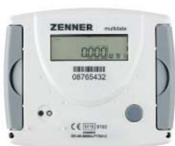
Un compteur d'énergie thermique est toujours formé de 3 composants: un élément de mesure de volume, une paire de sondes de température et un calculateur. La quantité d'eau qui circule dans le circuit de chauffage est évaluée par le biais de l'élément de mesure du volume. ZENNER crée des solutions adaptées individuellement pour la mesure du volume allant du mesureur à jet unique à la technologie ultrasons.
