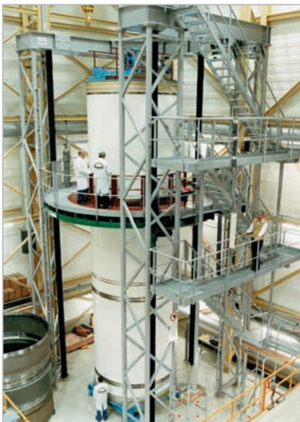
Dispositif de levage volant avec protection par soufflet pour une course de 9 m environ. Photo d'usine MT Aerospace AG.
