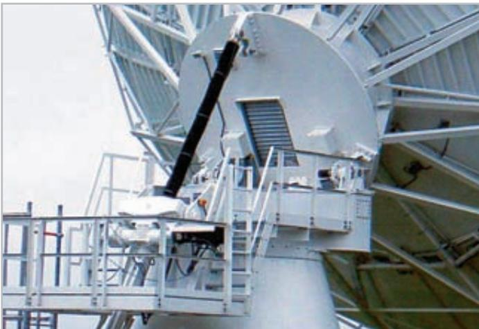
Vérin à vis sans fin HSE hautement performant en version spéciale pour mouvement élévatoire de 0° à 90° d'une antenne de 11,1 m
