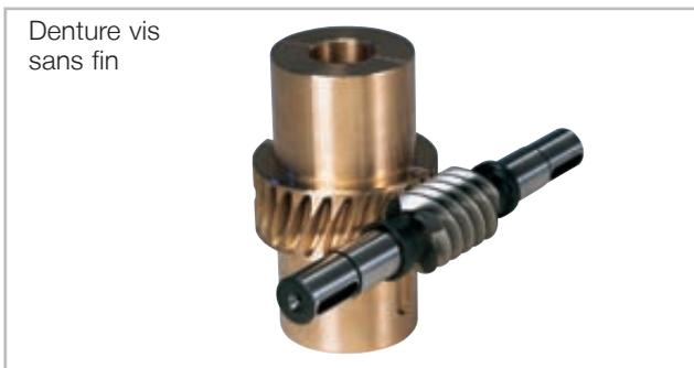
Le jeu de denture de la vis sans fin varie à l'état neuf entre 0,1 et 0,3 mm, et augmentera avec l'usure, en fonction des dimensions et de l'entraxe.
