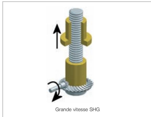
Le mouvement d'entraînement est appliqué sur la roue conique, par l'intermédiaire du pignon de commande. Mouvement de rotation résultant de l'assemblage solidaire de l'axe dans la roue conique. Le mouvement de levage s'effectue par l'immobilisation en rotation de l'écrou de levage par l'intermédiaire de la structure à déplacer. La position de la roue conique (Ro = Roue en haut / Ru = Roue en bas) détermine le sens de rotation (voir construction 1).
