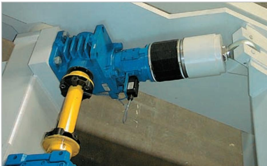
Vérin à vis sans fin HSE hautement performant, type 1 en entraînement tandem synchronisé par allonge élastique.
