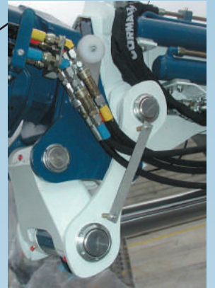
Angolo negativo tra prolunghe e JIB (10 gradi). Negative angle between extensions and JIB (10 degrees). Angle négatif entre extensions et JIB (10 degrés). Negativ Winkel zwischen Ausleger und jib (10 Grad).
