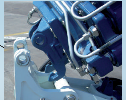
Aggancio/Sgancio rapido JIB Quick connection and disconnection of the JIB Connexion rapide de JIB Schnellkupplung des Jib (für die Hydraulik: hydraulische Schnellkupplung)
