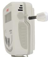
Après avoir emboîté votre KISTOCK sur la plaque de fixation, insérer le tube pour verrouiller le système de fixation.
