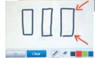
L'écran LCD tactile multifonction permet de tracer une esquisse et de marquer l'image avec le stylet.
