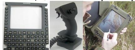
Calculateurs complets, Line Replaceable Unit (LRU) : sur cahier des charges, normes DO-160E et DO-178B
