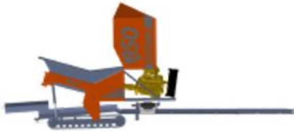
La structure supérieure de la machine peut être inclinée vers l'arrière, tandis que la sous-structure, solidement reliée au châssis, permet de déplacer facilement le panier de criblage sur un rail dans cette position - sans avoir à démonter les arbres. L'ensemble du couvercle peut être soulevé hydrauliquement pour l'entretien de l'unité d'entraînement. Très silencieuse –80 db (A)
