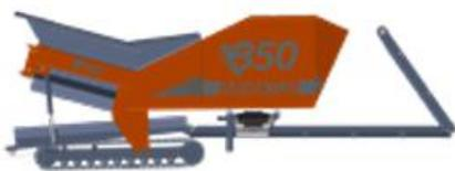
Pour le transport, la superstructure est abaissée hydrauliquement. Le tapis de déchargement peut être abaissé et incliné pour assurer une position de transport compacte.
