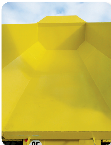
Caisse TP en V ou caisse standard avec rayon de 120 mm V-shaped public work body or standard body radius 120 mm
