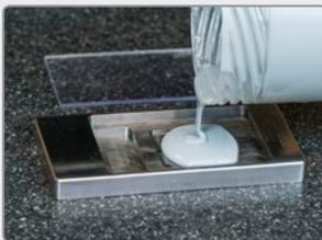
1. Placez le moule de calibration revêtement sur une surface plane et remplissez entièrement le compartiment échantillon avec le revêtement de test.
