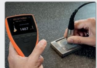
4. Prenez une mesure au même endroit avec l'Elcometer 500. Entrez la valeur d'épaisseur de film sec et enregistrez-la dans la liste de Matériaux de revêtement de l'Elcometer 500.
