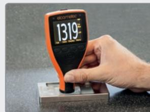
3. Une fois le revêtement entièrement sec, calibrez une jauge d'épaisseur de revêtement modèle Ferreux sur le bord du CCM; mesurez ensuite l'épaisseur de film sec et notez la valeur au centre du revêtement.
