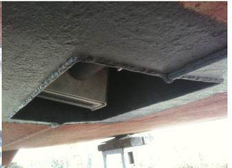
L'écoulement sur ces bases acoustiques doit être laminaire; il dépend de la forme de la carène, c'est pourquoi une étude par un architecte naval s'impose.
