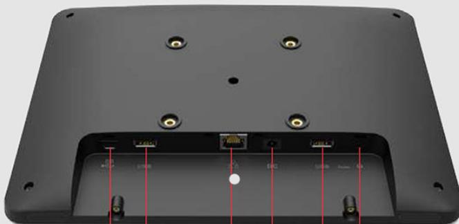
Micro SD    USB    Ethernet    Entrée DC    USB    Sortie audio
