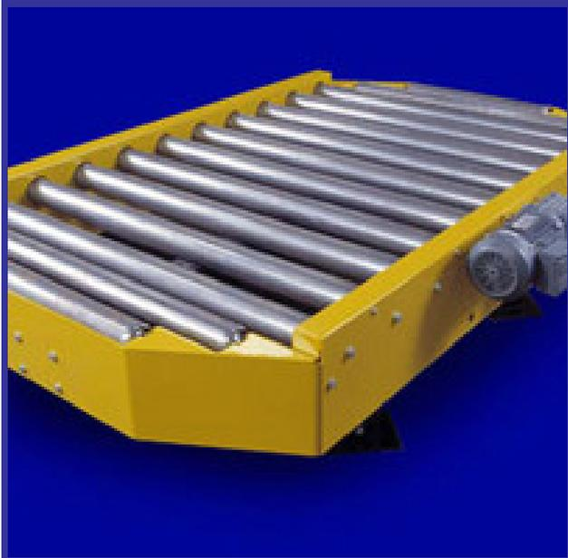
La table tournante est utilisée pour le transfert de palette dans un circuit de convoyeurs tout en conservant son sens de circulation.
