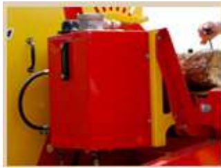
Centrale hydraulique débit 41 L/min Réservoir 40 L
