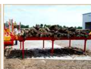
Deck à chaîne 3 ou 5 m + démêleurs rotatifs en étoile
