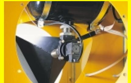
Le diffuseur d'air renforce et distribue l'air comprimé pour donner le maximum d'effet réduisant radicalement la consommation d'air comprimé.
