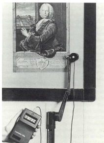
Fig 4 Adaptateur pour les musées avec trépied pour des mesures dans des espaces très réduits
