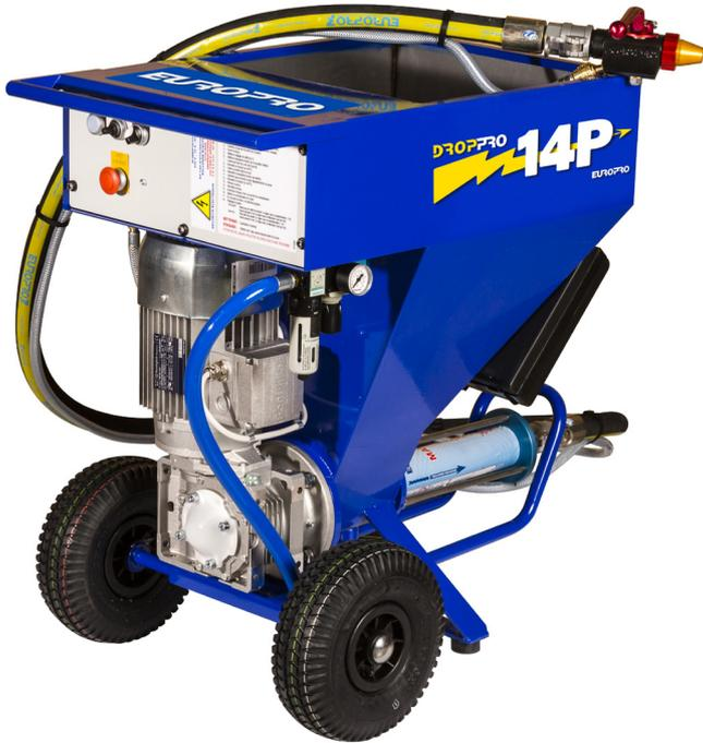
Equippée d'une cuve inox 57 L, DROPPRO 14P est une machine à projeter maniable et facile à utiliser.
