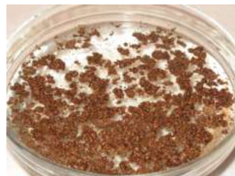
- LISORB GH+TL ayant absorbé que l'huile - agglomération du LISORB a saturation
