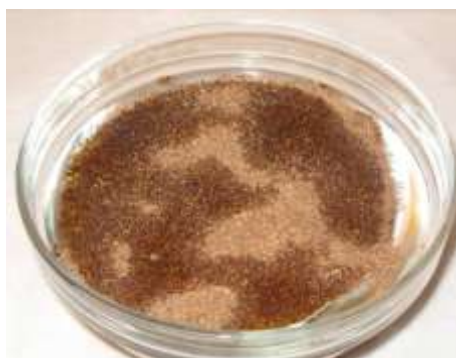
- LISORB GH+TL ayant absorbé que l'huile - agglomération du LISORB a saturation
