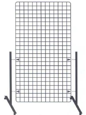
Schéma de montage pour une grille autonome, avec 2 pieds.
