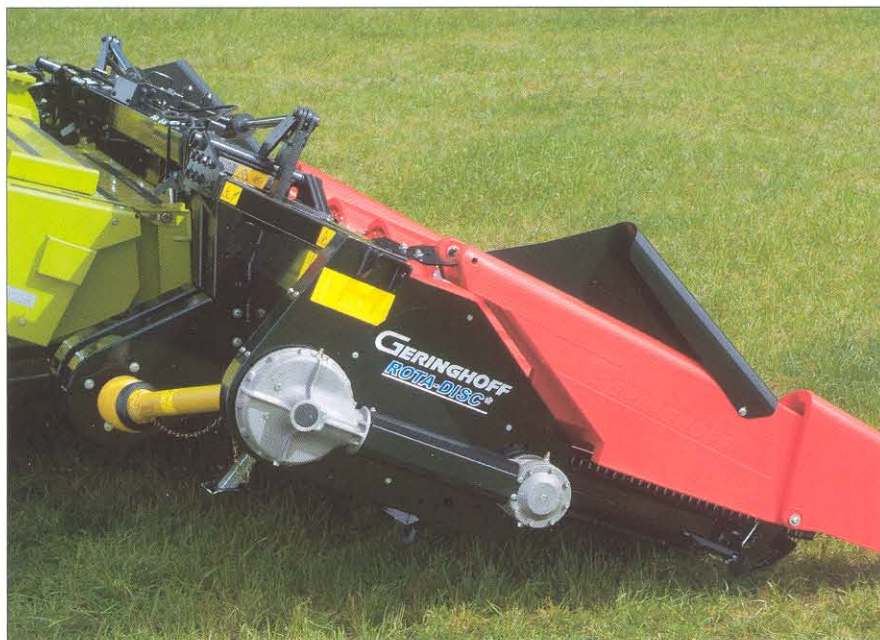
Liaisons des rangs rabattables avec accouplements flexibles axiaux à détente automatique.
