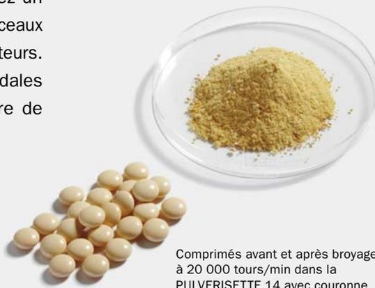
Comprimés avant et après broyage à 20 000 tours/min dans la PULVERISETTE 14 avec couronne de broyage et tamis à perforations trapézoïdales de 2 mm
