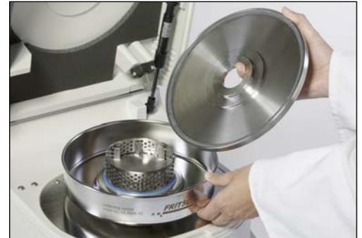
Grande économie de temps : **changement rapide des outils du broyeur**, ce avec très peu de manipulations et sans outil, nettoyage très simple des pièces en dehors de l'appareil.
