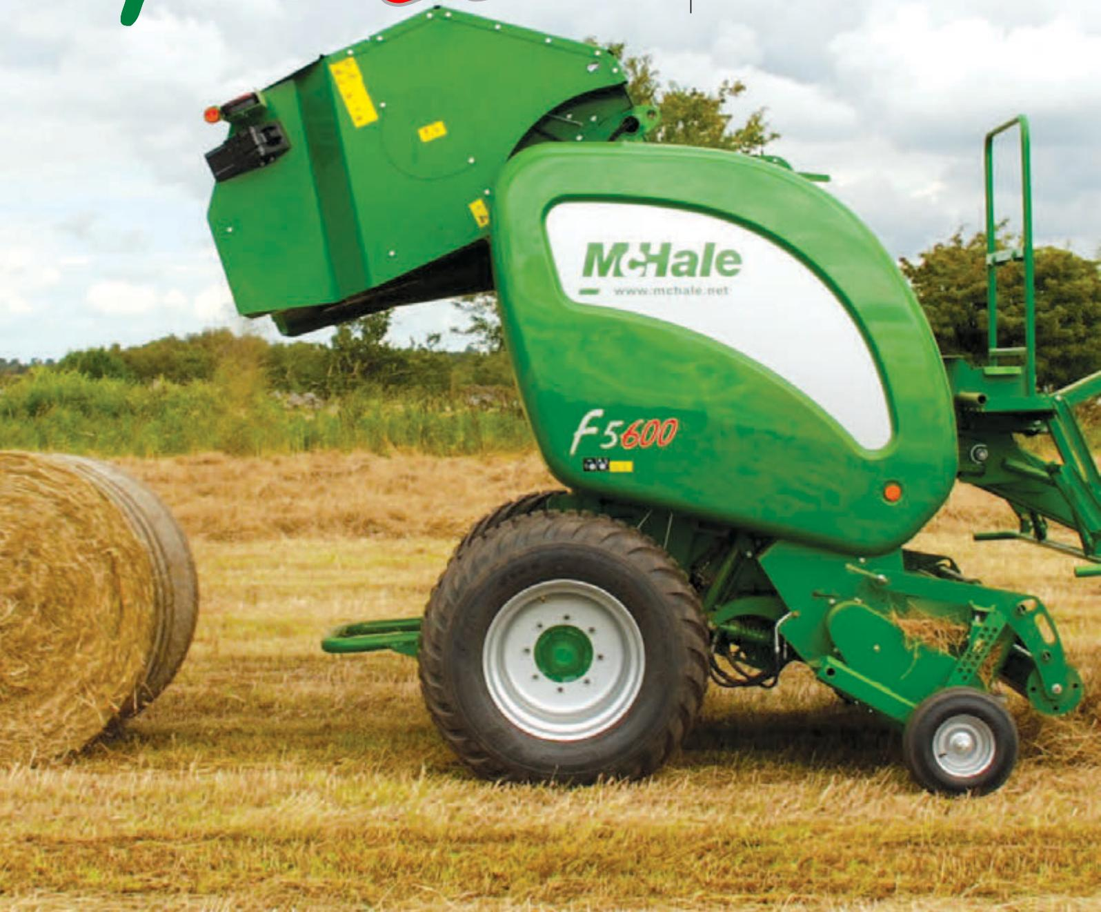
La Mchale F5600 est équipée d'un système hydraulique Load Sensing, ce qui rend le processus de pressage entièrement automatique. La machine est également équipée d'un système de coupe de 25 couteaux.
