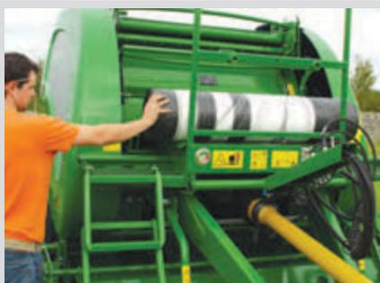
Le chargement du filet a été optimisé sur la gamme de presses F5000 par un système simple et efficace de chargement du rouleau de filet de rechange. L'opérateur libère simplement les sangles du rouleau de filet de rechange sur la plateforme de la machine et déplace celui-ci de sa position de stockage vers son emplacement de travail en le faisant rouler. Le stockage du rouleau de filet de rechange s'effectue à l'avant de la presse.
