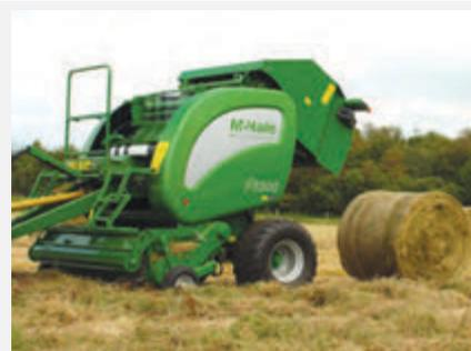
Une fois la balle terminée, elle sort de la chambre et l'éjecteur de balles permet d'obtenir une distance suffisante entre la machine et la balle tout juste pressée. La conception de l'essieu permet une meilleure garde au sol et l'essieu en 8 trous permet de mieux résister aux terrains difficiles.
