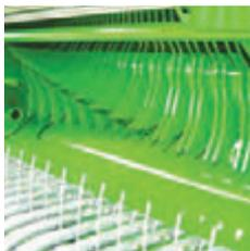
(II) L'ameneur rotatif ou l'unité de coupe dispose d'un rotor renforcé et d'un peigne. Sur toutes les machines F5000, les étoiles du rotor sont soudées des deux côtés pour une plus grande robustesse. De plus du côté entraîné, le rotor est équipé d'un roulement à double rangée pour une longue durée de vie.
