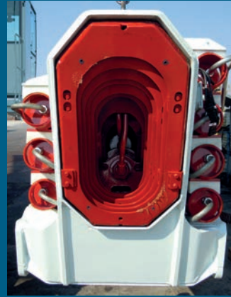
Sezione poligonale delle prolunghe, sistema Cormach The boom extension with polygonal structure, CORMACH design Polygonal Ausschube, CORMACH System Bras a structure polygonale, Système CORMACH
