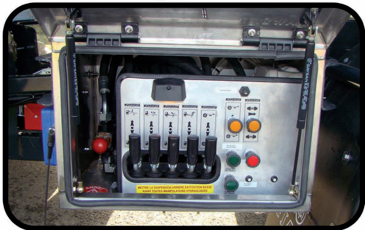
* Commandes hydrauliques dans un coffre inox avec éclairage automatique
