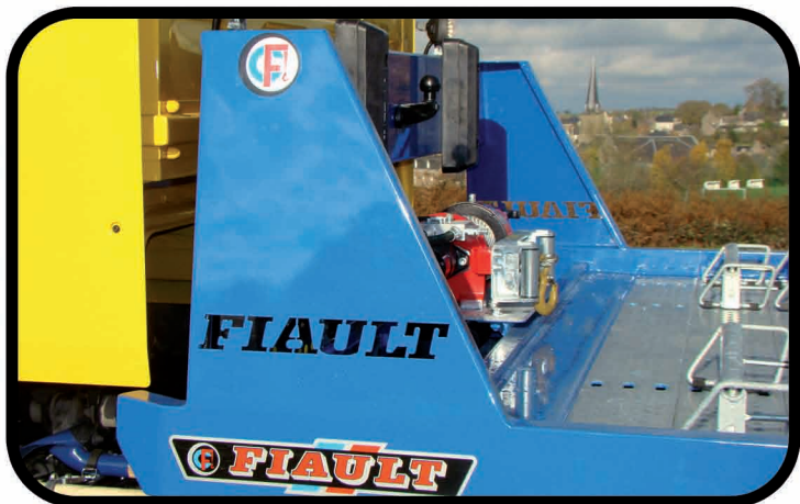
* Roll-bar avant standard avec butoirs de protection de cabine en caoutchouc
