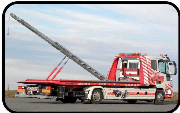
* Flèche hydraulique CRANELIFT, capacité 2T
