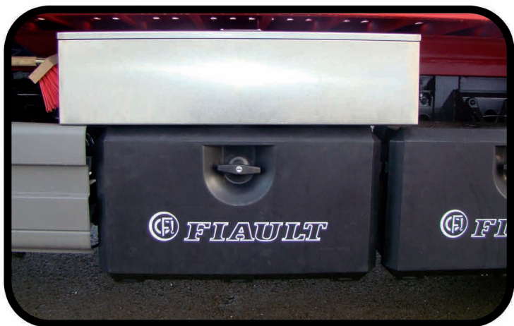
* Coffre à outils anti-chocs en polyuréthane et bac de rangement en aluminium
