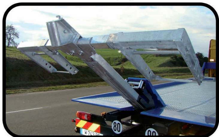
* Combiné flèche panier galvanisé et réglable type COMBILIFT 3T - 4T avec tête de grue
