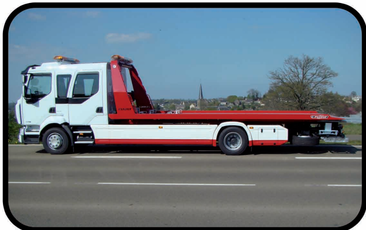
* Carénage intégral en polyester avec coffre à outils et coffre de commande hydraulique AR
