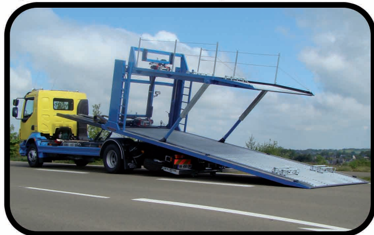
* Etage type 1, 2 ou 3 avec poteaux anti-chutes et treuil sur étage
