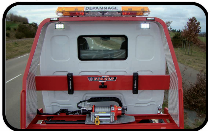
* Roll-bar surélevé type FLY, doublage en alu, rampe lumineuse avec rappel des feux et feux flash
