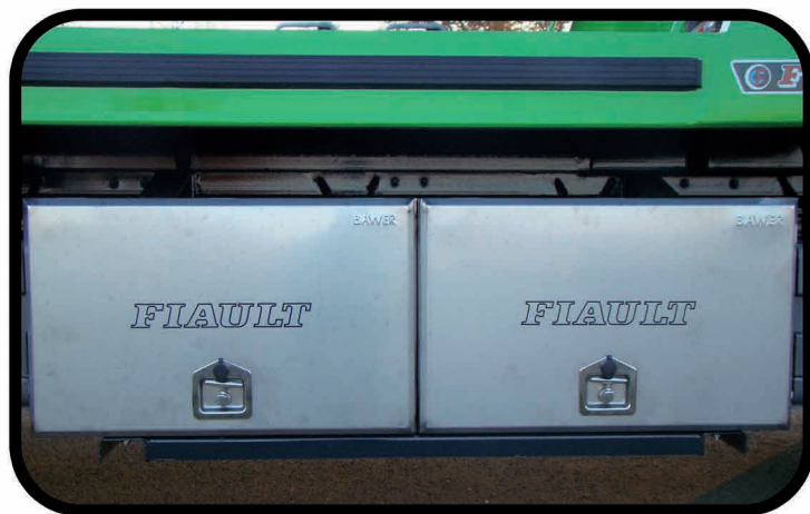
* Coffre à outils en inox avec porte articulée et galon de protection de rive du plateau
