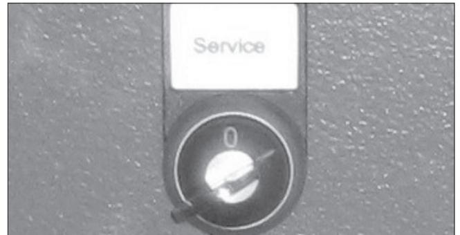
En cas d'intervention sur le cylindre, la presse ou le circuit d'air comprimé, le cylindre est déplacé en position réparation. Voir le chapitre Entretien.
