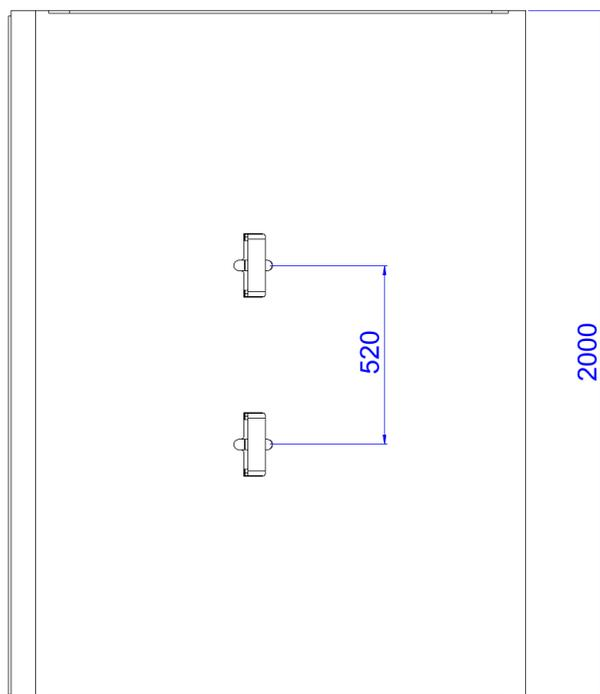
Cette rampe se déplace facilement grâce aux deux fourreaux de fourche disposés sur sa face supérieure à l'aide d'un chariot élévateur.
