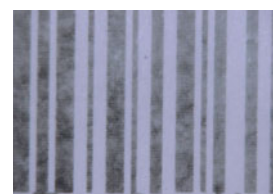
Impression pâle (papier thermique)
