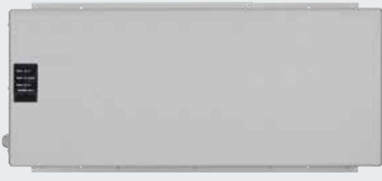
Dispositif UPS Pour alimentation en cas de pannes d'électricité jusqu'à 4 heures, permettant le maintien du fonctionnement des dispositifs de sécurité, feux de signalisation, etc., affichage d'état par LED, test automatique de la batterie et filtre de surtension. Dimensions : 560 x 235 x 260 mm (L x H x P). Indice de protection : IP 20.
