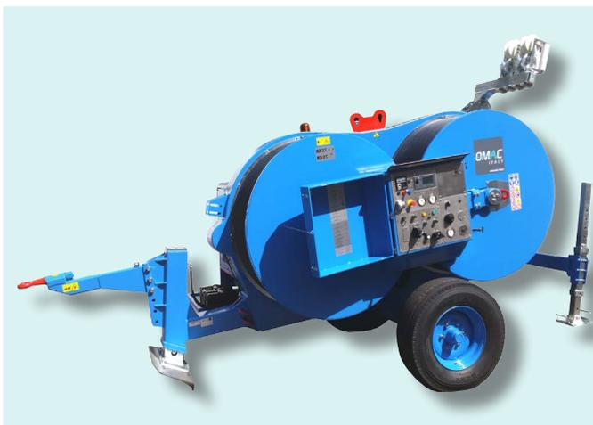
Machine hydraulique conçue pour travailler soit comme freineuse soit comme treuil, adaptée pour le tirage d'une ou deux câbles ou pour le déroulage d'un ou deux conducteurs. Un circuit hydraulique permet d'appliquer une force de freinage constante même à la variation de la vitesse de déroulage. En fonction treuil, un circuit hydraulique permet de varier la vitesse dans les deux directions.
