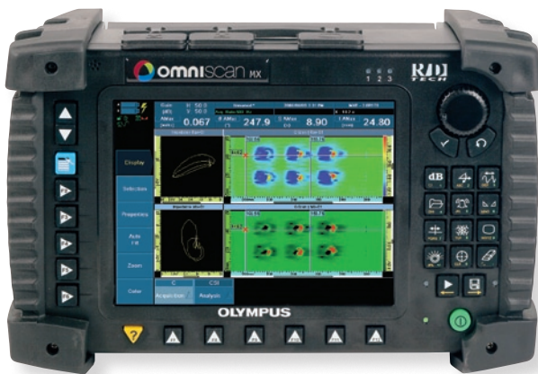
Inspection de rivets avec 2 fréquences et affichage d'un double C-scan
