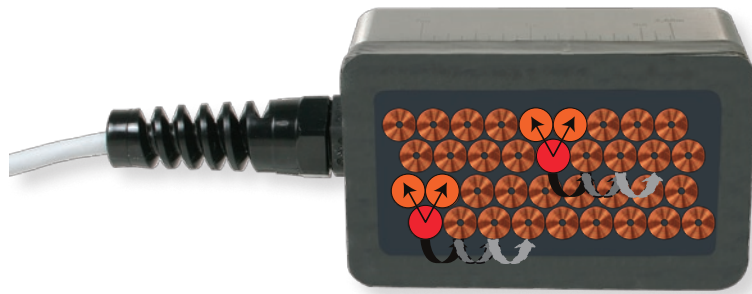
Principe du multiplexage entre les éléments. Les bobines sont montrées pour les besoins de l'illustration seulement.
