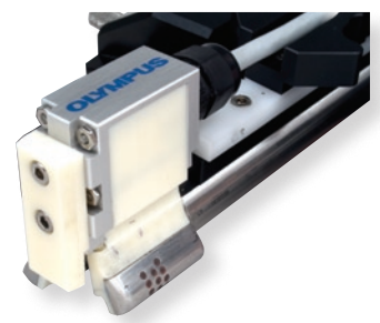
Les sondes peuvent être fabriquées en diverses formes et tailles afin de mieux s'adapter aux contours de la pièce à inspecter
