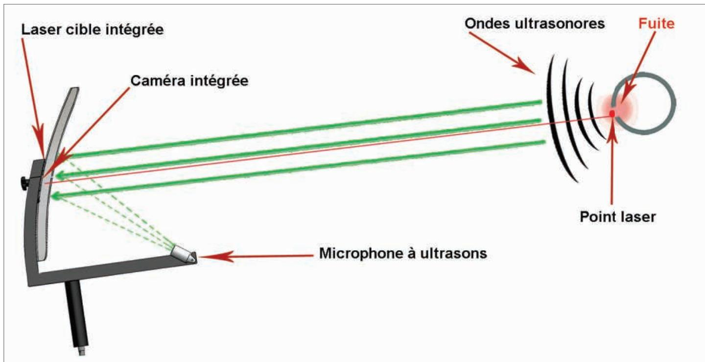
Par concentration des ondes ultrasoniques dans le miroir parabolique, même de faibles fuites de 0,8 l/min (environ 8 € par an) peuvent être localisées avec précision ( $\pm 15$  cm), et à des distances allant jusqu'à 10...15 mètres. La forme du miroir parabolique garantit que seules les ondes ultrasoniques de la fuite visée soient analysées. Quant aux bruits parasites, ils sont réduits au minimum.
