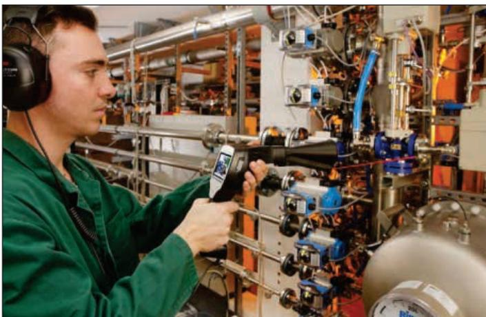
Le casque insonorisé permet la recherche de fuites, même dans un environnement bruyant. Il restitue un signal sonore audible, image des mesures ultrasons, convertie sur une fréquence audible et filtré du bruit environnant. Le laser permet une localisation précise.
