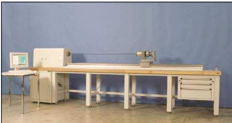
Modèle 210S.1000 Nm.H permettent des éprouvettes jusqu' à 2 m de longueur.
