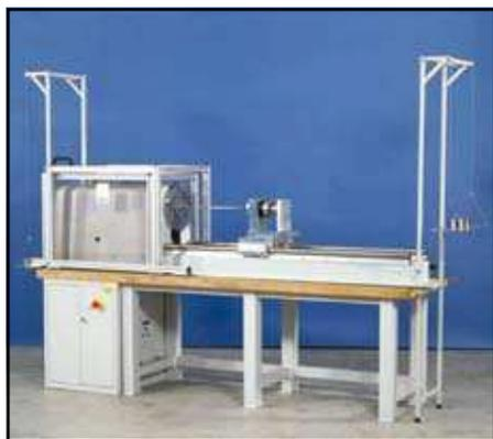
Modèle 210S.500Nm avec dispositif pour les charges axiales
