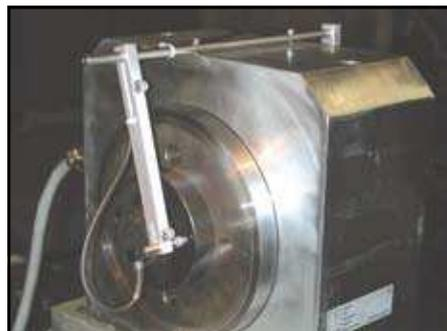
Capteurs à composants multiples avec palpeur pour la mesure des variations de la longueur
