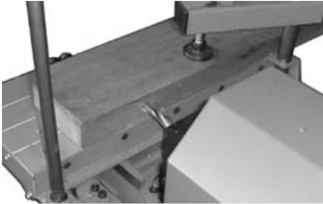
Fig. 5: Perçage de mortaises avec ou sans butée de profondeur
