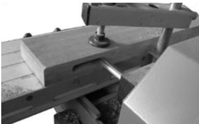
Fig. 6: Mortaisage d'une mortaise longue
