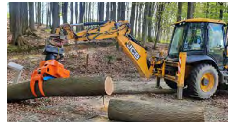
Grappin à bois, robuste et à faible usure avec unité de sciage.
