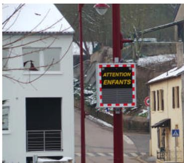
Un afficheur/radar installé sur un mât d'éclairage public avec sérigraphie sur mesure
