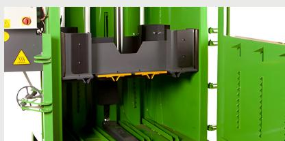
Force de compactage réelle de 50 tonnes et vérin à course longue pour une force de compactage maximale produisant des balles de 400 à 500 kg
