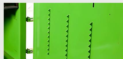
Configuration unique intégrant des doigts de retenue mobiles et fixes pour un compactage optimisé
