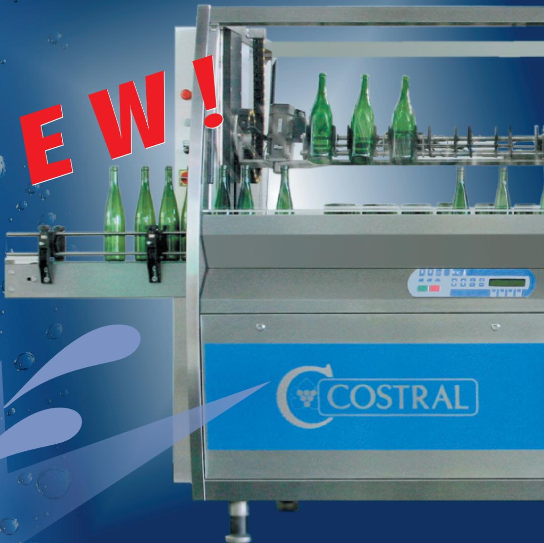
La nouvelle génération "NEPTUNE" se caractérise principalement par son très long temps de cycle. Ainsi, en version rinceuse, la forte injection d'eau permet une parfaite élimination des contaminants, suivie d'une très longue séquence "bouteille retournée" assurant un égouttage exceptionnel.
