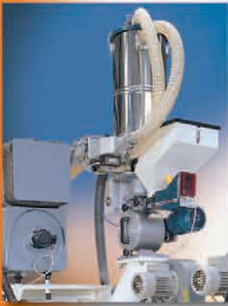
Con ADG montato direttamente sull'estrusore si ottengono i migliori risultati sul prodotto dosato. E' comunque possibile l'installazione a terra su strutture fisse o mobili per alimentare più estrusori che utilizzano anche ricette diverse; oppure inserito in impianti centralizzati per alimentare più linee.
