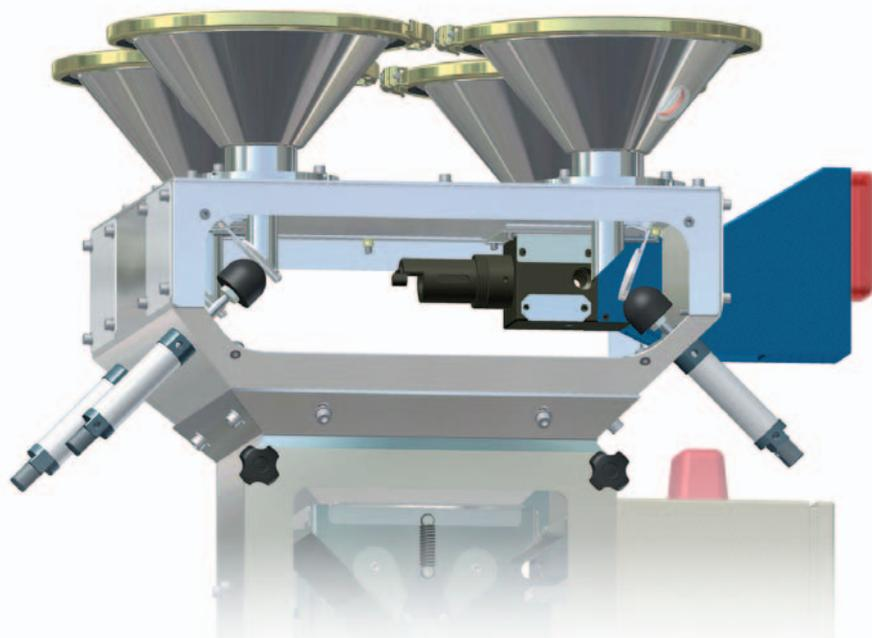
La caída de los material sobre la tolva pesada está controlada por obturadores basculantes comandados neumáticamente. No existe de este modo el peligro de obstrucción de los obturadores debido a polvos u otras cosas, ya que no hay nada mecánico que se desplace en sobreposición.
