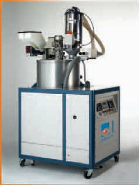
Con ADG montado directamente sobre la extrusora se obtienen los mejores resultados sobre el producto dosificado. También es posible la instalación en tierra sobre estructuras fijas o móviles para alimentar más extrusoras que utilicen recetas distintas, o bien insertado en instalaciones centralizadas para alimentar más líneas.
