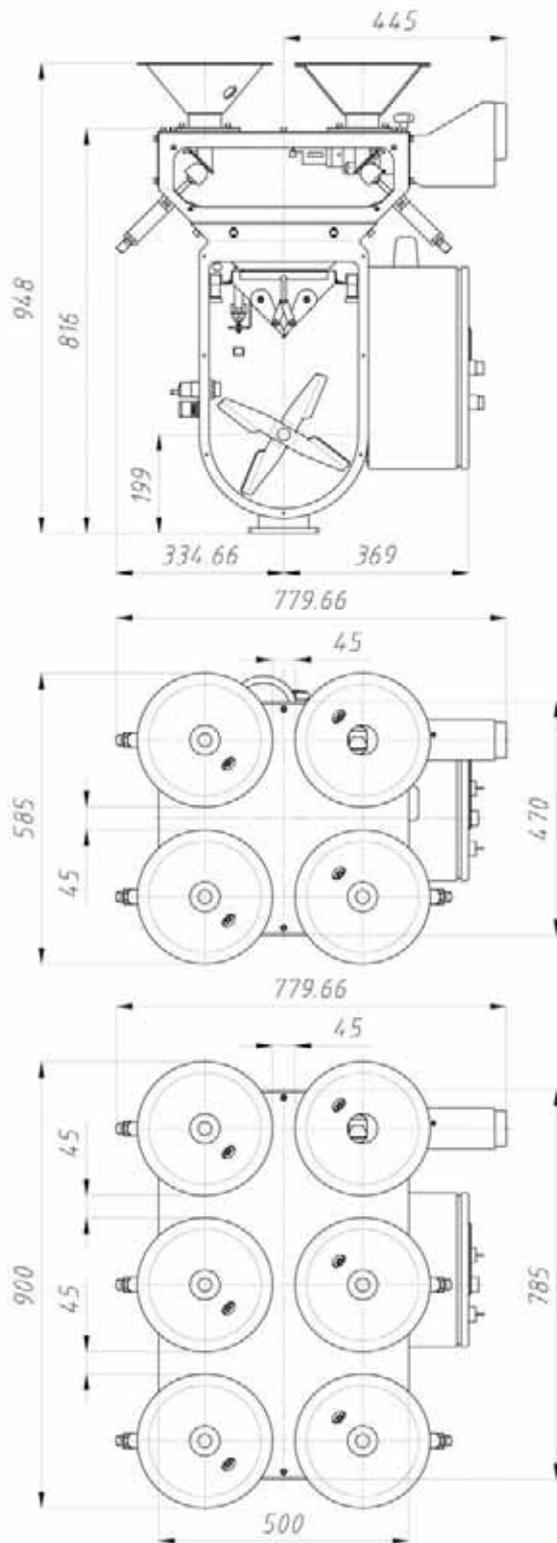
La tipologia di allestimento della macchina è modulare da 2 a 8 componenti.
