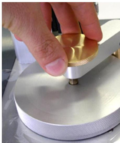
TotalPerm è conforme alle norme DIN 53380-3 e ASTM F2622 per la misura di O<sub>2</sub>TR, alla norma ASTM F2476 per le misure di CO<sub>2</sub>TR ed alla norma ASTM F1249 per le misure di WVTR.
