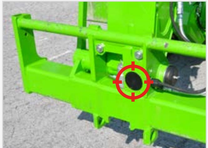
Capteur placé sur le tablier
